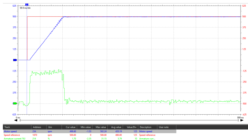
Figura 5-9: Valore di Speed reg P troppo alto, oscillazioni della corrente di armatura e della velocità
